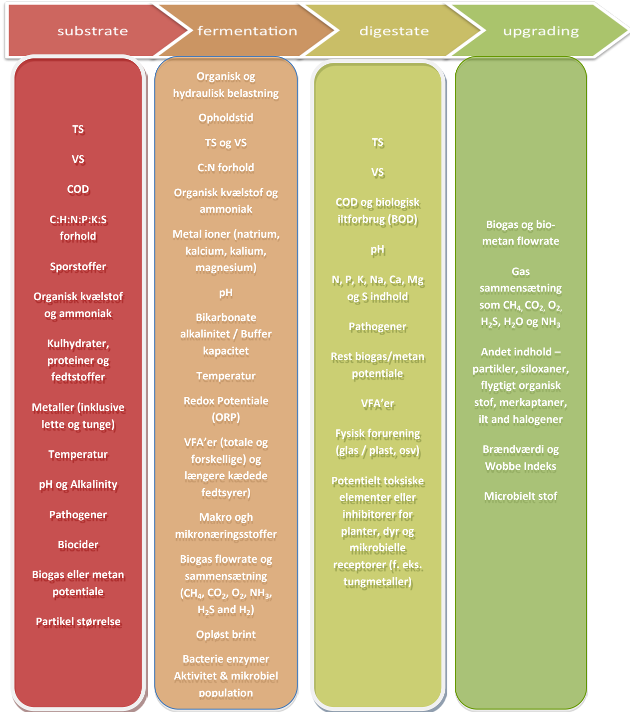
Figure 3 – Monitoringsparametre for hvert trin i procesmatrix, der er relevante for drift af rådnetanksanlæg
